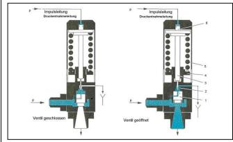
Die Kegel (1,2) und der Kolben (6) werden gleichzeitig vom Systemdruck P beaufschlagt. Bis zum Betriebsdruck PB wird das Vorsteuerventil (2) nicht vom Kolbenstößel (3) berührt; alle Kegel sind vom Druck voll beaufschlagt, es herrschen aunstiaste Abdichtbedingungen.
