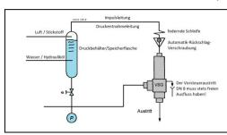
Die rechts/links Gewindemutter (SW 27) kann Druck unter gelöst werden. HD-Luft die entweicht durch die Entlüftungsbohrung, bis nach ca. 2 Umdrehungen das Automatik Rückschlag-Ventil schließt
